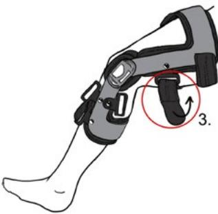
**6. PL:** Przepleść przez klamrę i dopiąć tylny pas udow oznaczony nr. (3) Uwaga; napięcie tylnego pasa powoduje przesunięcie zegara do tyłu, i dlatego należy tak dobrąć napięcie pasa albo po jego zapięciu zegar znajdował się dokładnie w osi stawu kolanowego.
